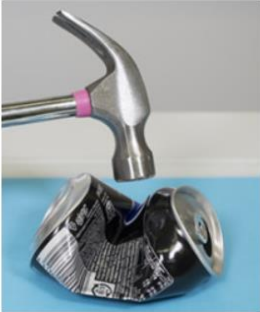
Kuva 54. Metalleja voidaan takoa ohuiksi levyiksi, sillä metallihilassa metalli-ionikerrokset pääsevät liukumaan toistensa ohi vapaiden elektronien "meressä" rakenteen murtumatta.
