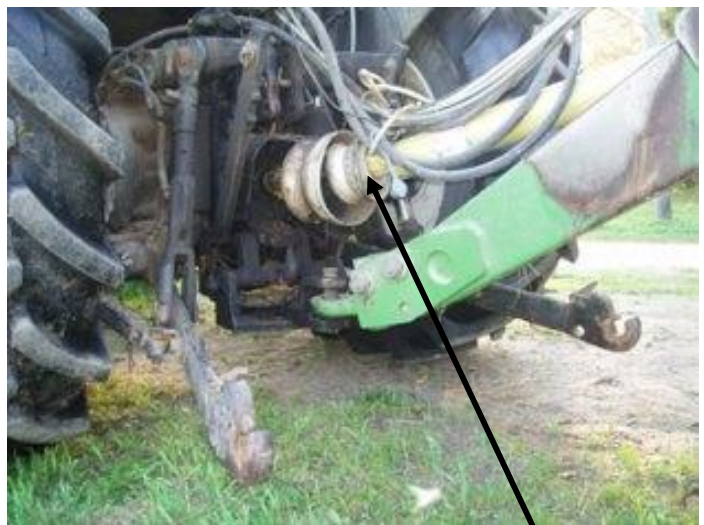
Kuvio 5 Noukinvaunun kytettä traktorin maatalousvetolaitteeseen. Vaalean keltainen nivelakseli on kytketty traktorin voimanulosottoakseliin
