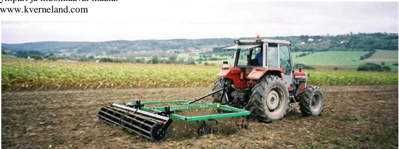
Kuvio 6 Vedettävä joustopiikkiäes, jonka kiinteät joustavat piikit eteenpäin liikkuessaan muokkaavat maata. ( www.kronos.fi )
