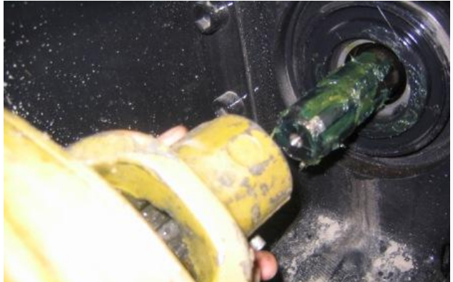
Kuvio 3 Nivelakselin kytettä voimanulosottoakseliin. Esim. lukitustappi painetaan sormella pohjaan ja nivelakseli työnnetään voimanotto-akselin uritukseen.
