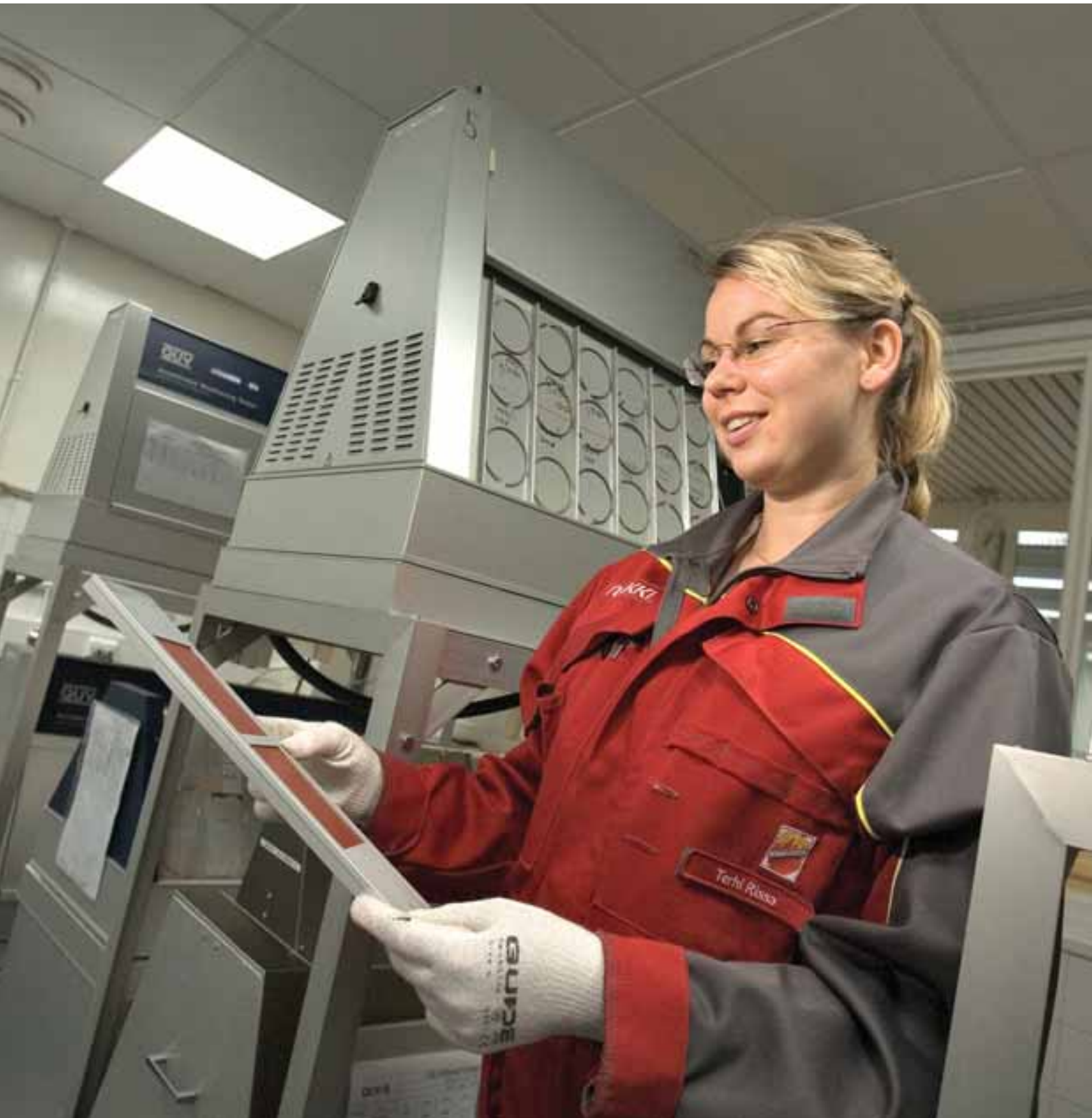
UV-testinäytteen arviointia Hämeenlinnan tehtaan tutkimus – ja kehityskeskussessa (T&K).
