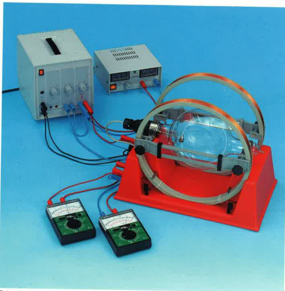
Elektronin ominaisvarauksen määrittäminen
