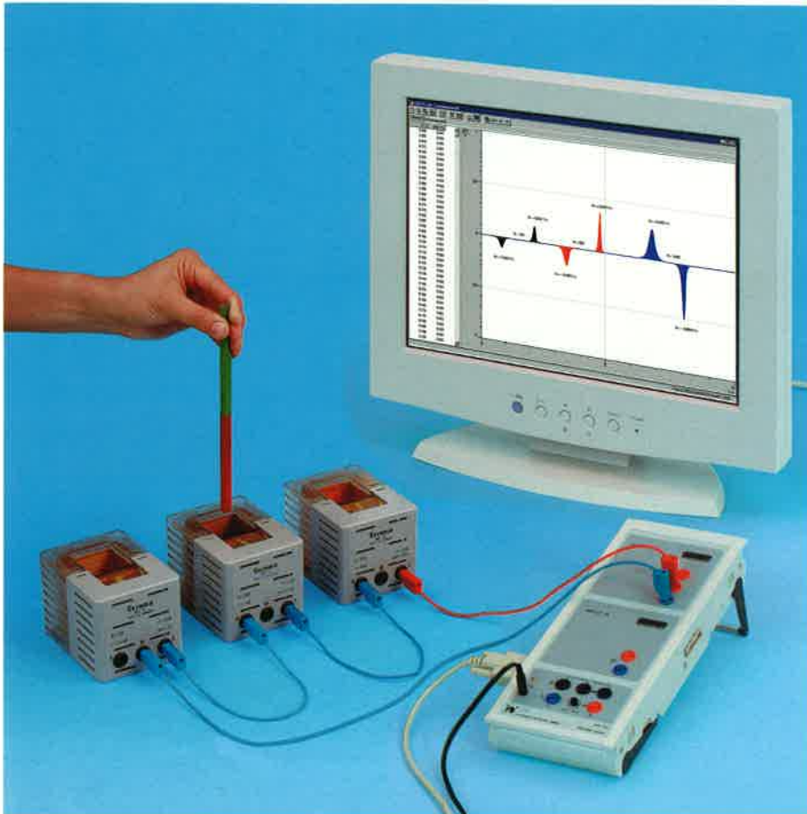
Jännitepulssien tuottaminen liikuttamalla kestopagneettia johdekelassa
