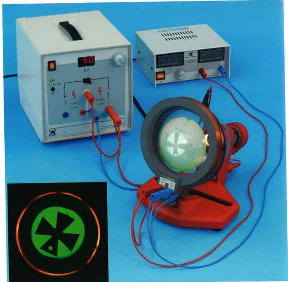
Elektronien poikkeaminen aksiaalisessa magneettikentässä
