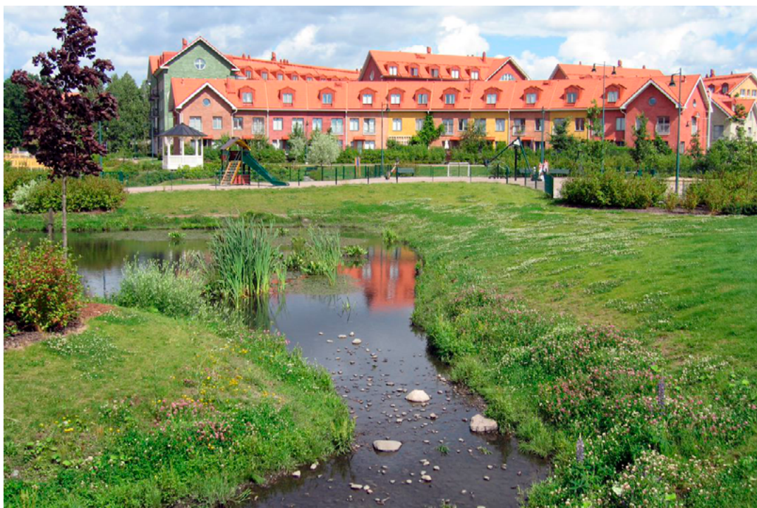
Kuva. Hulevesikosteikko on viihtyisää katseltavaa, ja mukava leikkipaikka lapsille. Kosteikko lisää myös alueen monimuotoisuutta tarjoten elinympäristön erilaisille kasveille ja eläimille. Kosteikko viivyttää hulevesivirtoja ja kosteikon ympäröivä kasvisto sitoo vedestä ravinteita ja mahdolliset haitalliset aineet imeytyvät maaperään. Kuva ottanut: Pirjo Ferin SYKE
