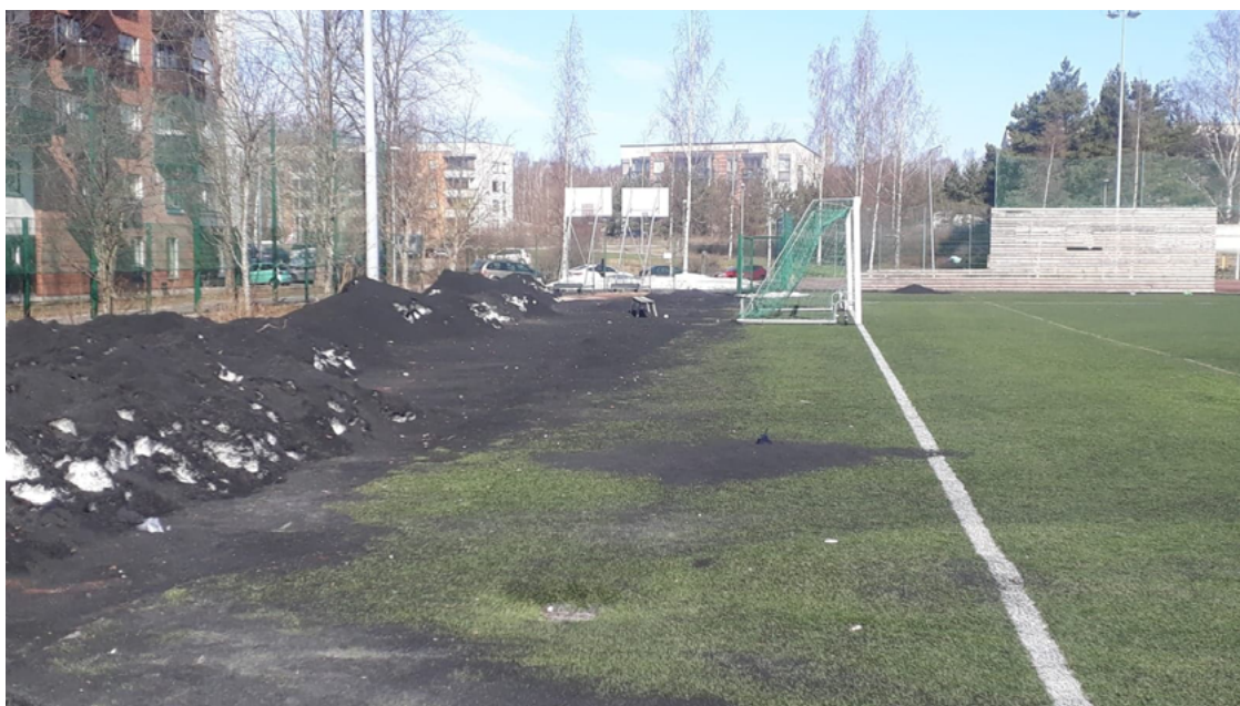
Tekonurmikentän lumikasoihin on kerääntynyt valtavat määrät kumirouhetta. Kuva: Erika Sainio, SYKE
