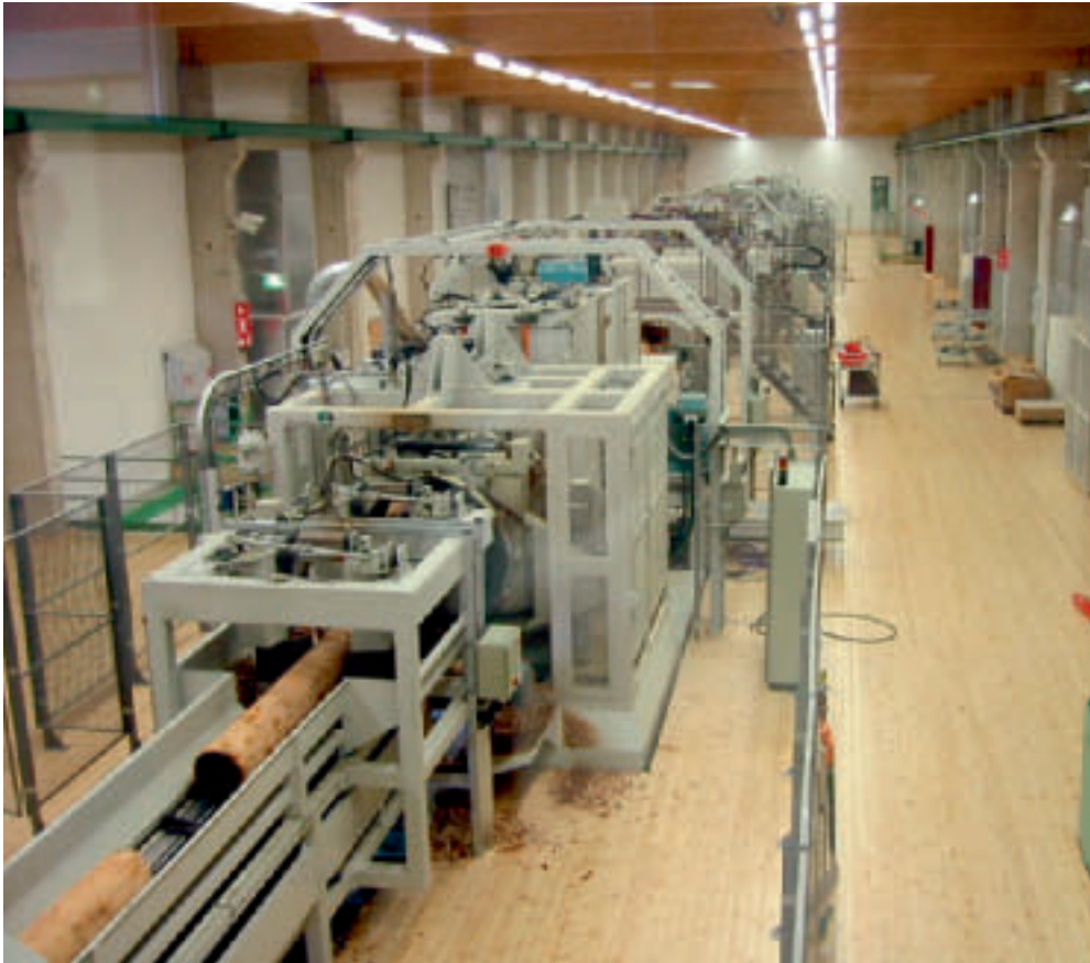
Kuvassa HewSaw SL250 Quartet sahalinja UPM:n Seikun sahalla Porissa. Sahalinja on asennettu vuonna 2002. Tukkikoko: 10–45 cm, syöttönopeus: 60–150 m/min, tuotantokapasiteetti: 400 000 m 3 /vuosi kolmessa vuorossa.
