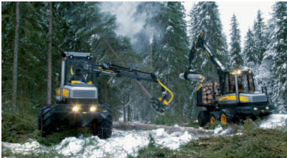
Hakkuu- ja ajokone tekemässä ja kasaamassa tilauksen mukaisia puutavaralajeja.
