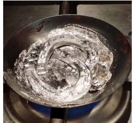
Kuva 9 Lämpötila vaikuttaa olomuotoon. Kun lämpötila on alle 327 °C, lyijy on kiinteä aine. Kun lämpötila on yli 327 °C, lyijy on neste.
