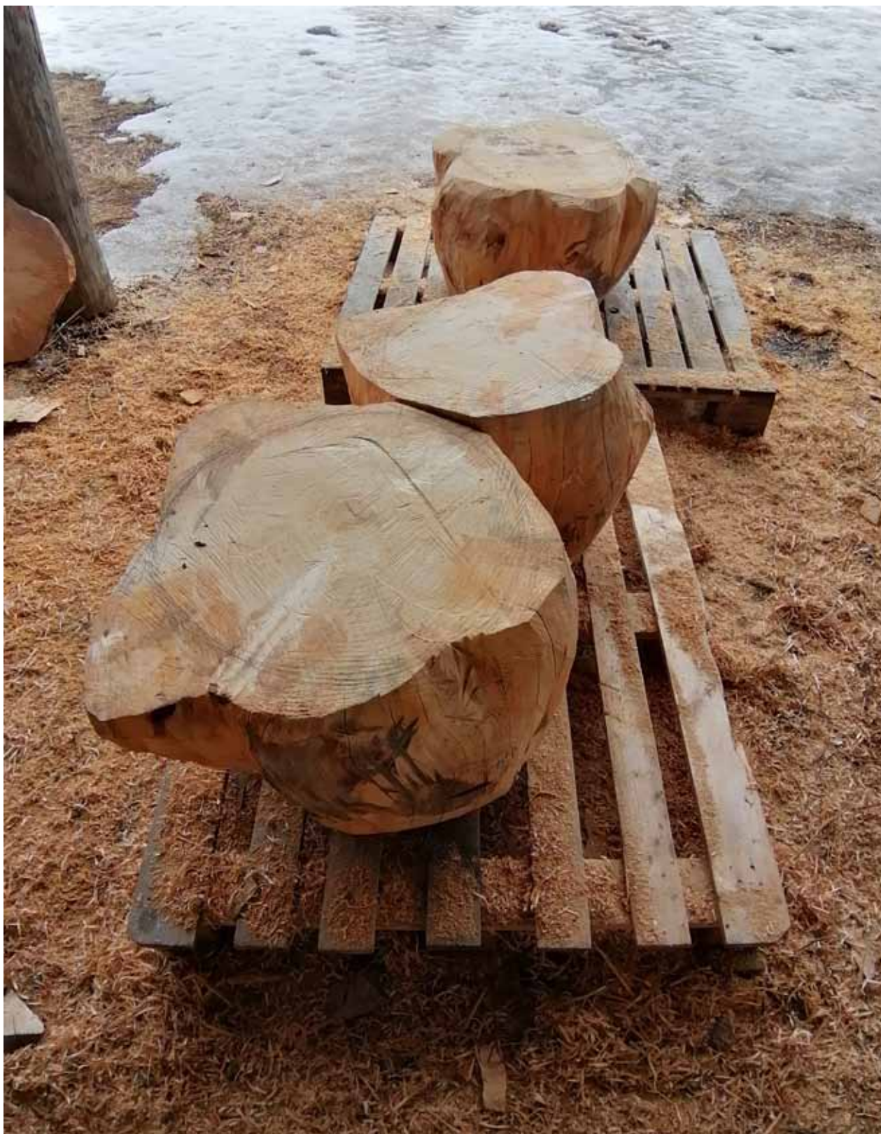
Penkkien muoto alkaa hahmottua karkean työstön, eli moottorisahan ja kirveen, jäljiltä. Sitten siirryinkin hiomakoneen käyttöön. Puun nopeasta kasvusta johtuen sitä oli hieman hankala työstää taltalla, se tahtoi lohkeilla helposti, mutta hiomalla ja maltilla sai hyvää muotoa kuitenkin aikaiseksi.
