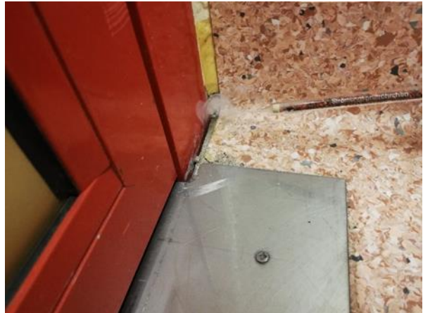
Kuva 13: Merkkisavumittaus vanhan- ja laajennusosan välillä.
