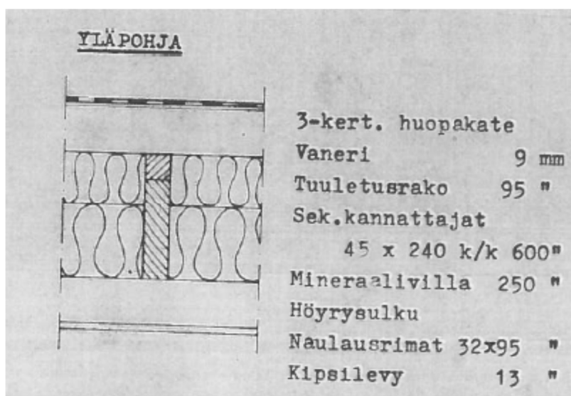
Kuva 32. Suunnitelmien mukainen tasakattorakenne.
