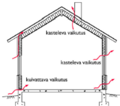
Kuva 5.26. Konvektion vaikutus rakenteiden kastumiseen ja kuivumiseen. Ilmavirtausten suunnat voivat tietyissä tilanteissa olla myös toisinpäin kuin kuvassa.
