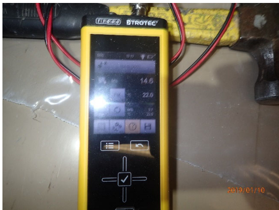
Kuva 11. Alempi alaohjauspuu oli kuiva 14,6 paino-%.
