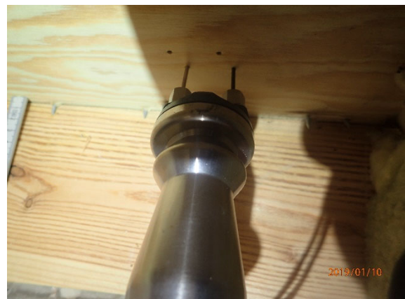
Kuva 9. Vaneri oli hiukan alaohjauspuuta kosteampi, mutta kuitenkin kuivaksi luokiteltava alle 18 paino-%.
