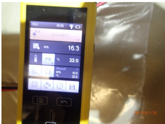
Kuva 9. Vaneri oli hiukan alaohjauspuuta kosteampi, mutta kuitenkin kuivaksi luokiteltava alle 18 paino-%.
