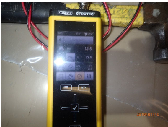
Kuva 11. Alempi alaohjauspuu oli kuiva 14,6 paino-%.
