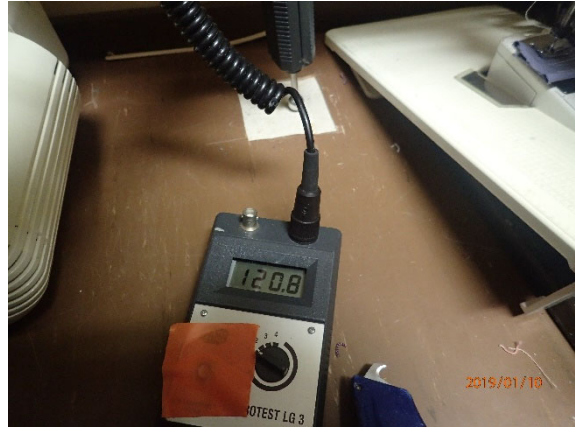
Kuva 28. Käsityövaraston materiaalinäyte ja pintakosteustulos. Tilan pintakosteuksissa oli samansuuntaisia poikkeamia pintakosteuslukemissa kuin luokassa 136.
