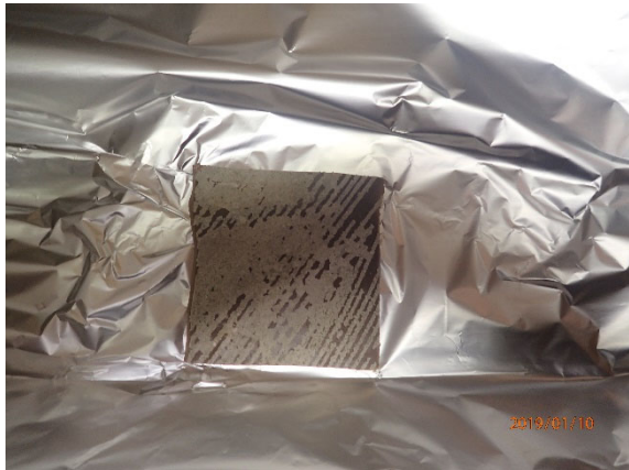
Kuva 28. Käsityövaraston materiaalinäyte ja pintakosteustulos. Tilan pintakosteuksissa oli samansuuntaisia poikkeamia pintakosteuslukemissa kuin luokassa 136.
