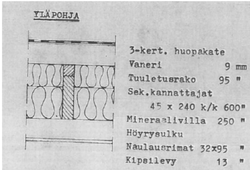
Kuva 32. Suunnitelmien mukainen tasakattorakenne.
