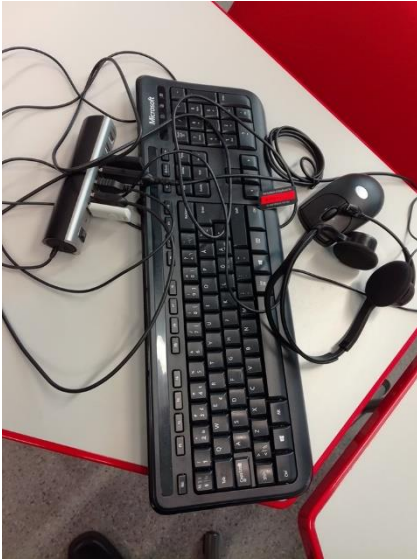
Kuva 1. Pahimmillaan kokelas on joutunut ostamaan useita lisälaitteita aivan uuteen Macbookiin: USB-hubi, jolla saa 6 lisäporttia, USB-hiiri, USB-näppäimistö, USB-kuulokkeet, USB-Ethernet-sovitin, USB-WLAN-sovitin. Kaikkia ei kuvassa näy.
