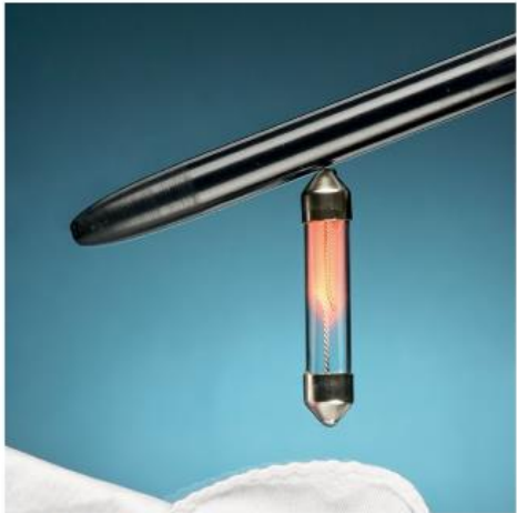
Hohtolamppu ja muovisauva. Sauvan varaus on negatiivinen.
