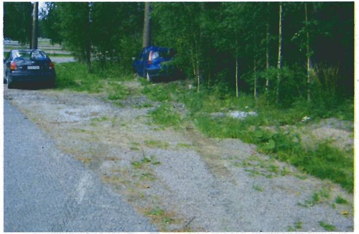
TIE kaartui vasemmalle, Fiat jatkoi matkaansa suoraan. Etupyörät lukossa oleva auto jatkaa aina liike-energian suuntaan ohjauspyörän asennosta riippumatta.
