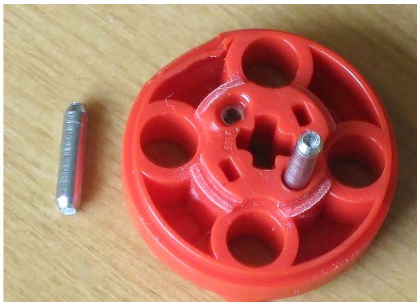
Terästapit ovat katkenneet moottoria avattaessa
