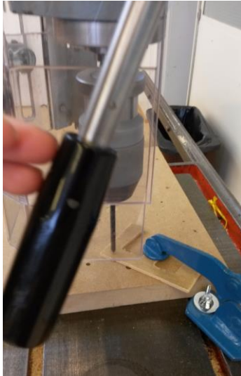
Kuva 5. Ruuvipuristin ja pylväsporakone.
