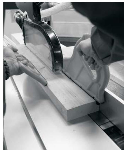
Koneilla työstettäessä suositellaan käytettäväksi suojavarusteita, kuten esimerkiksi työntökahvoja. Kuva Käsityön työturvallisuusoppaasta (s.71)
