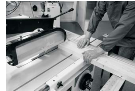
Teräsuojan korkeus kappaleen pinnasta saa olla enintään 8 mm. Sama koskee myös muun muassa vannesahan teräsuojaa. Oppaassa korostetaan myös suojavaatteiden istuvuuden merkitystä ja erityisesti sitä, että hihansuut eivät saa roikkua. Kuva Käsityön työturvallisuusoppaasta (s.71)
