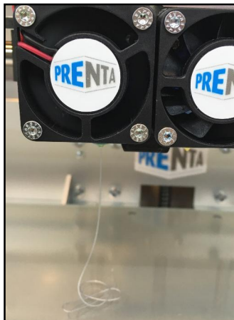
KUVA 24. Materiaalia tulee suuttimesta.
