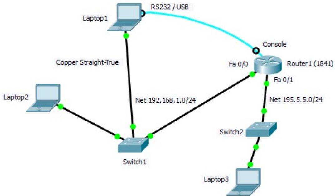
Asennetaan yllä oleva verkko ja konfiguroidaan työasemille ja reitittimelle taulukon mukaiset asetukset. Kopioidaan lopuksi asetukset muistiin ja testataan laitteiden väliset yhteydet.
