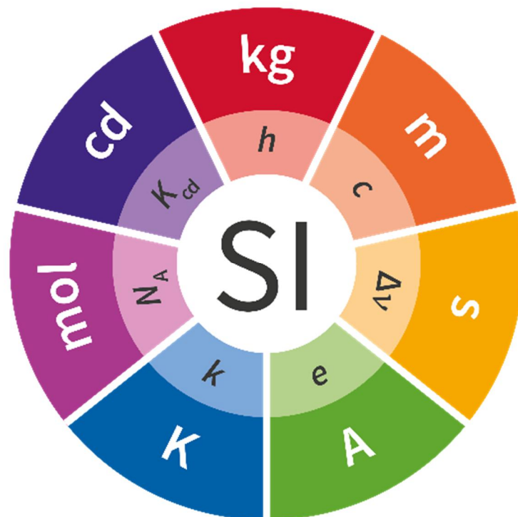
Kuva. SI-yksiköt ja ne määrittelevät vakiot uudistuksen jälkeen
