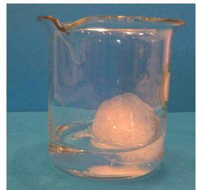
Kuva 12 Kiinteä jää sulaa nesteeksi, kun lämpötila on 0 °C. Veden sulamispiste on 0 °C.
