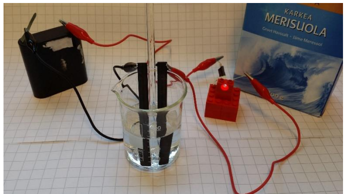
Kuva 47 Kun veteen lisää suolaa, sähkö alkaa kulkea veden läpi hyvin.
