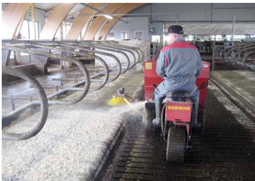
Kuva 18. Kuivikkeille on hyvä olla oma erillinen varastonsa, jossa ne pysyvät kuivina ja josta niitä voidaan siirtää eläinhalleihin välivarastoon tai hakea suoraan kuivituskoneella kuivitukseen. Konevoimin tapahtuva makuuparsien kuivitus ja parren takaosan puhdistus edistää karjanhoitajien hyvinvointia. Puhdas ja huolellisesti kuivitetu makuuparsi edistää myös eläimen hyvinvointia.
