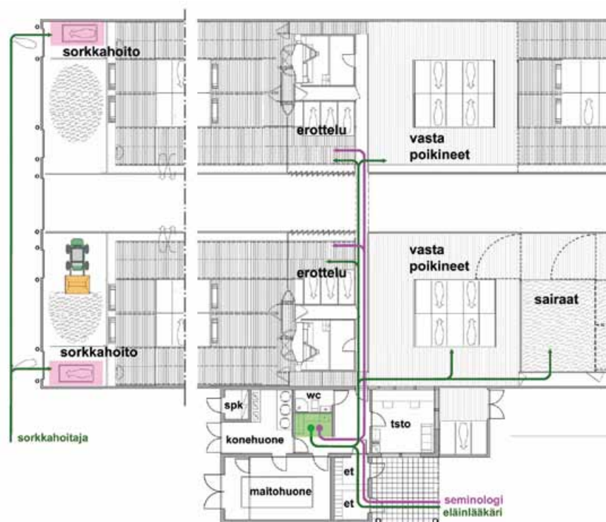
Kuva 17. Seminologit vierailevat pihatossa lähes päivittäin, jolloin heidän tuloreittinsä, työpisteensä ja kulkureitti toimenpidelehmien luokse on tehtävä mutkattomaksi, turvallisiksi ja hygieenisiksi. Sama koskee eläinlääkäreiden työskentelyolosuhteita. Sorkkahoitajan työpiste perustetaan mahdollisimman kauas lypsyasemasta/-robotista pihattohallin päätyyn tai sinne, mistä lehmät luontaisesti kulkevat laitumelle.
