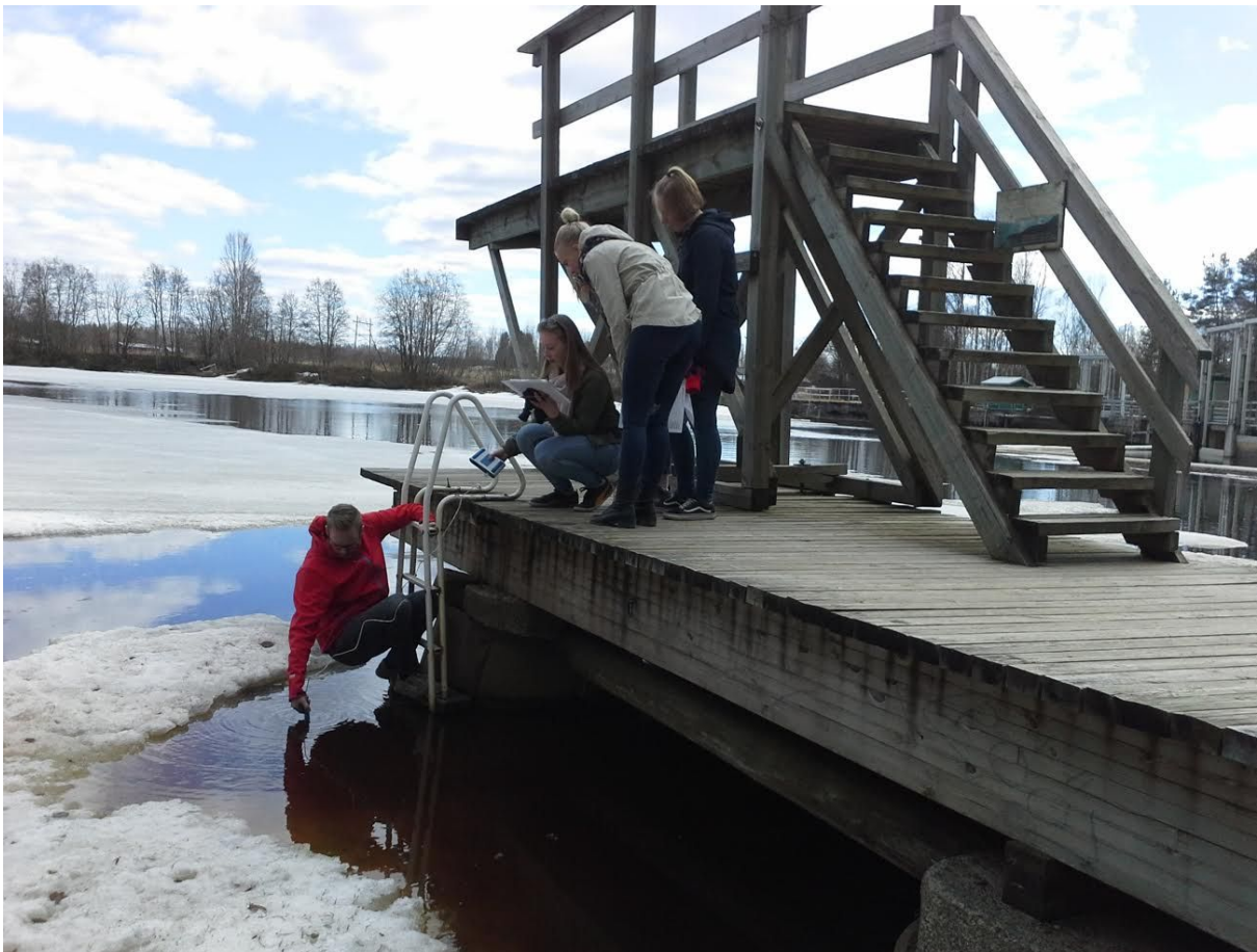
Kuva 1. Veden lämpötilan määrittäminen vesinäytteen keräämisen yhteydessä.
