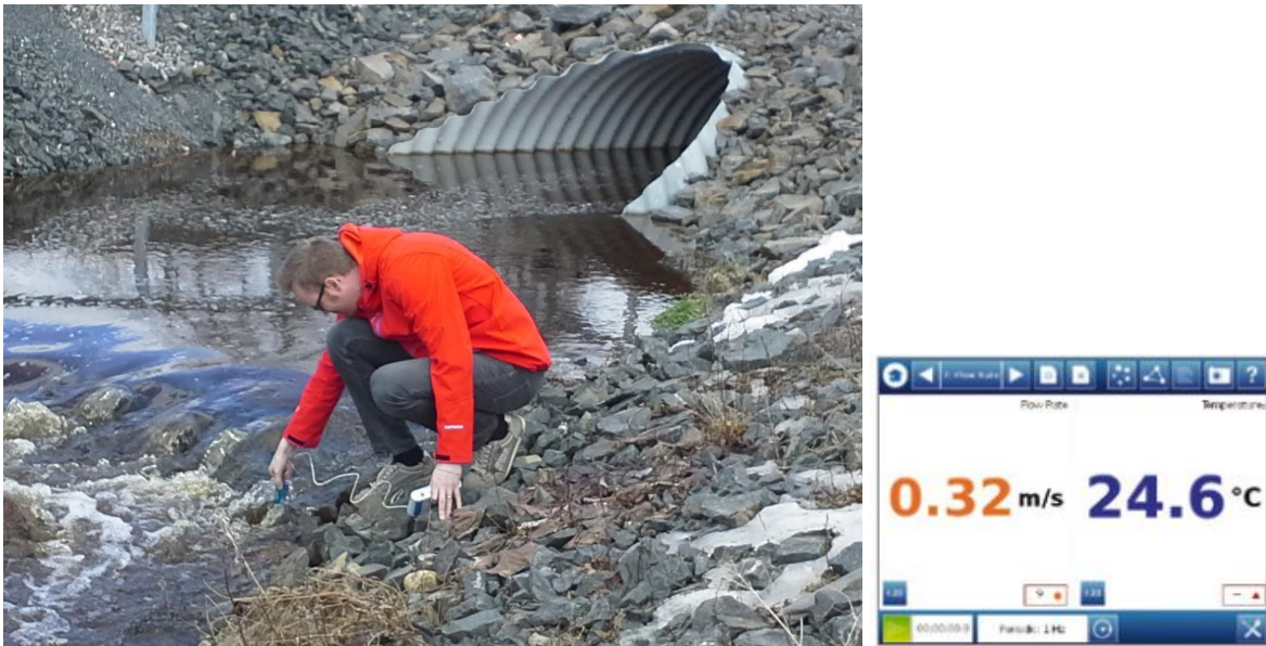
Kuva 2. Veden virtausnopeuden mittaaminen ja tulosten tarkastelua.
