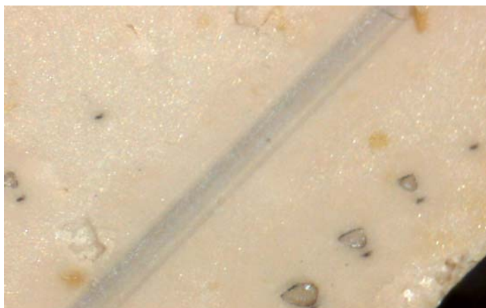
Kuva 12.3. Kraattereita ja pyyhkäisty viiva ST4-tabletin pinnalla. Kraattereita tehtäessä lasersäteen halkaisijat olivat 160, 120, 80 ja 40 µm. Viiva tehtiin halkaisijalla 160 µm. Teho oli 80 %, taajuus pisteitä tehtäessä 3 Hz ja viivoja tehtäessä 10 Hz, sekä lasersäteen liikuttamisnopeus viivalla 40 µm/s.
