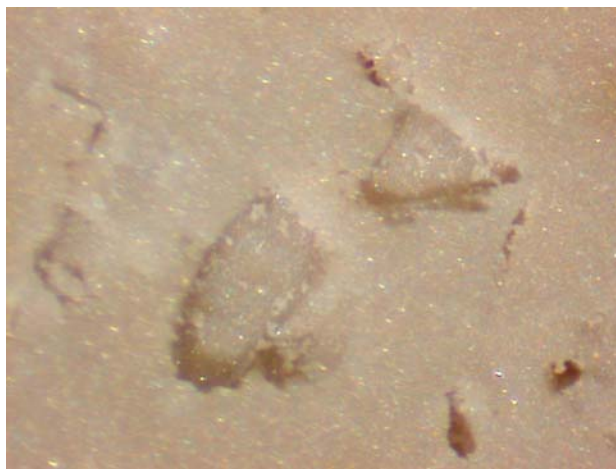
Kuva 12.5. Valomikroskoopilla otettu kuva näytteen ST4 pinnalla olevasta sulkeumasta. Sulkeuman halkaisija oli noin 300 \mu\text{m} .
