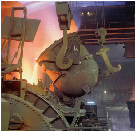
Kuva 5.17 Raakaraudan kaato mikseriin.
