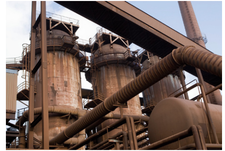
Kuva 5.9 Masuunin esikuumentimet eli cowperit.
