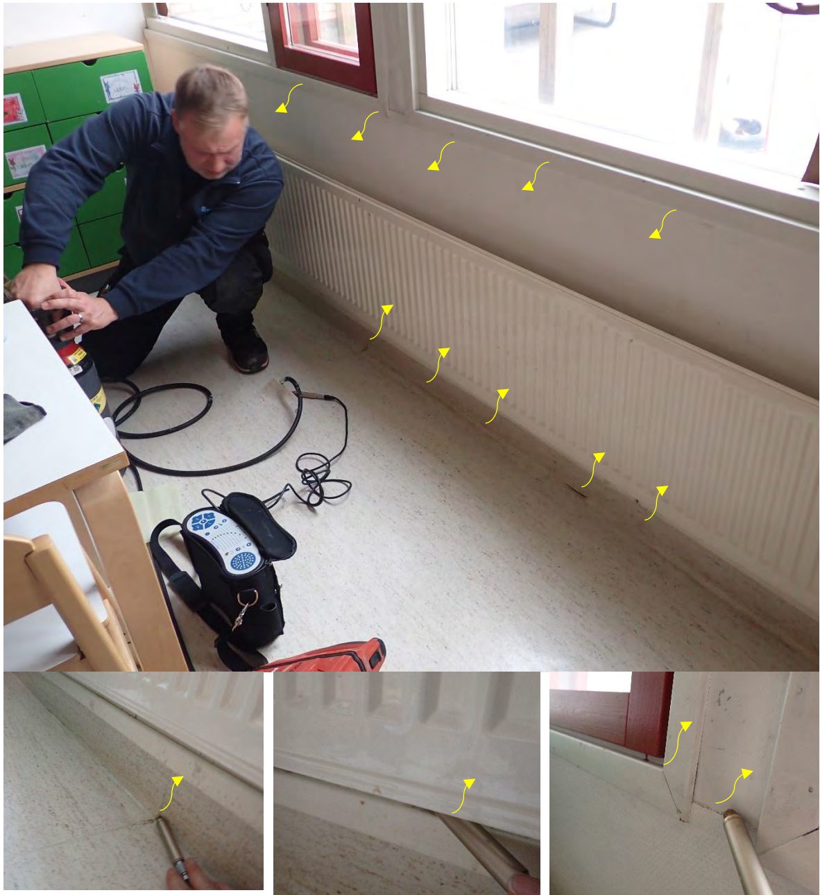
Kuvat 14–17. Huonetila ensimmäisestä kerroksesta. Todettuja ilmavuotokohtia osoitettu keltaisilla nuolilla.
