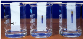
Kuva 33. Musta väri on uuden väriaineen seos. Väriaineet erottuvat omiksi täpliikseen paperikromatografian avulla, sillä ne kulkeutuvat nopeudeltaan liikkuvan faasin mukana.
