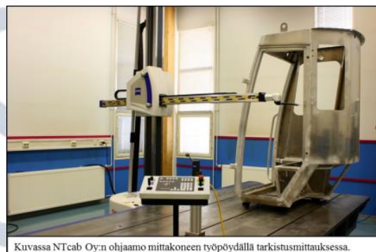
Kuvassa NTcab Oy:n ohjaamo mittakoneen työpöydällä tarkistusmittauksessa.
