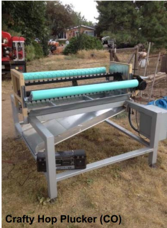
Figur 3. Plockmaskinen Crafty Hop Plucker från Colorado, USA. Utrustningen reparer kottarna från rankorna men rensar ej materialet. Uppgiften kapacitet 30-60 humlerankor per timme. Maskinen är eldriven (Callahan, 2013).
