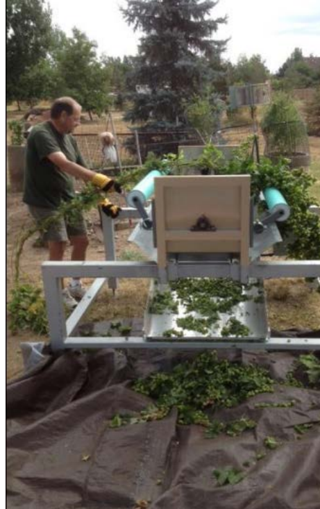
Figur 3. Plockmaskinen Crafty Hop Plucker från Colorado, USA. Utrustningen reparer kottarna från rankorna men rensar ej materialet. Uppgiften kapacitet 30-60 humlerankor per timme. Maskinen är eldriven (Callahan, 2013).
