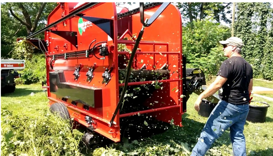
Figur 8. Mobil plockmaskin "Hopster 5" från företaget Hops Harvester LLC, USA. Bildkälla: YouTube 2017-12-06
