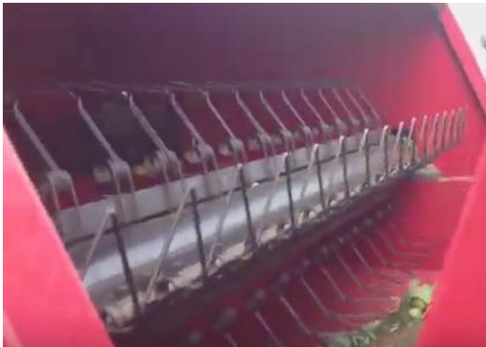
Figur 10. Bine Implement 3060, reparrotorn. Personen som svarar för inmatningen behöver med händerna hålla rankorna nära utrustningen för att reningen ska vara effektiv. Uppenbar skaderisk.
