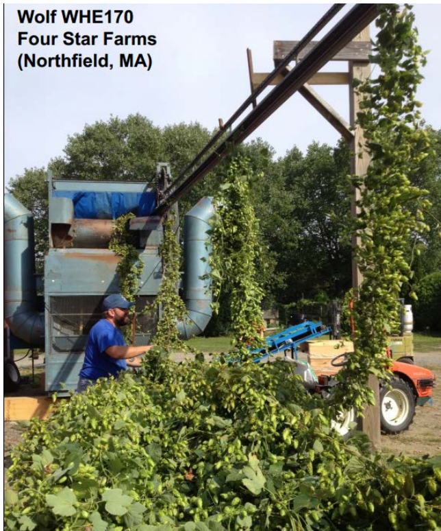
Figur 2. Repning och rensning av humle med den polsktillverkade plockmaskinen Wolf WHE 170. Humlerankorna hängs först upp i en transportör som för dem vidare till plockmaskinen. Kapaciteten är uppemot 170 rankor per timme (Callahan, 2013).
