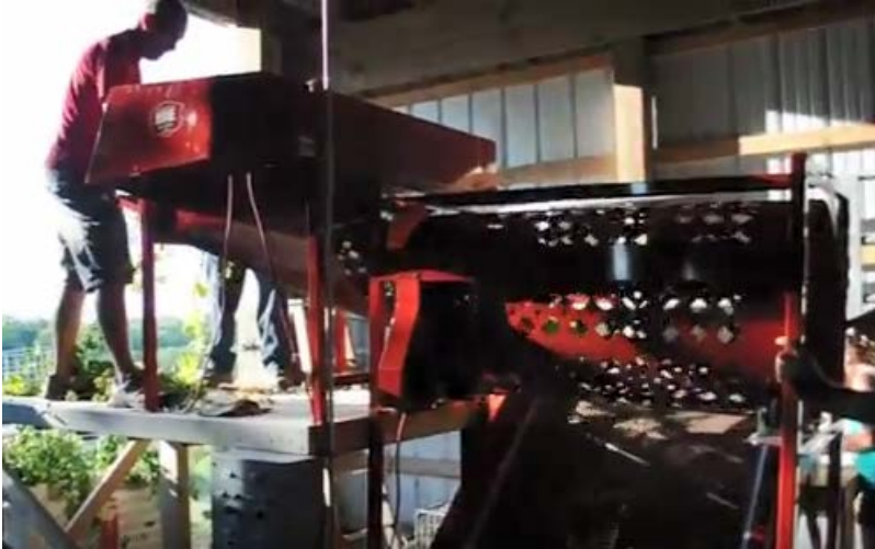
Figur 9. Arbete med plockmaskinen Bine Impement 3060. Humlerankorna matas för hand snett ovanifrån ner mot den roterande reparrotorn och dras sedan tillbaka. Arbetsmomentet upprepas tills kottarna är avrepade. Reparrotorn behöver placeras framför/ovanför enheter som rensar materialet. I rensningsfunktionen ingår en roterande trumma och ett genomsläppligt transportband som med hjälp av undertryck skiljer blad från kottar. Fallrisk. Bildkälla: YouTube november 2017
