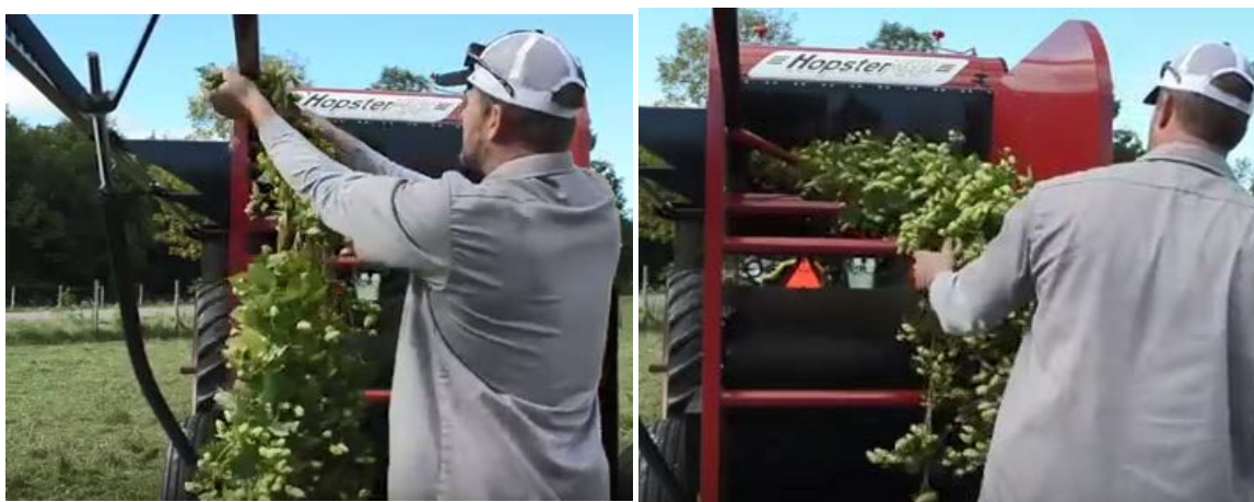
Figur 12. Arbete med plockmaskinen Hopster 5. Operatören knyter fast en ranka på en av matarkedjans fästkrokar. Detta sker under drift. Sedan leder operatören rankan in i maskinen för bästa passage med tanke på repningsresultatet.
