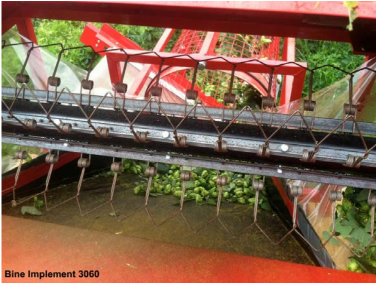
Figur 4. Amerikansk plockmaskin, Bine Implement 3060. Utrustningen repar kottarna och rensar materialet. Uppgiven kapacitet 20-30 rankor per timme (Callahan, 2013).
