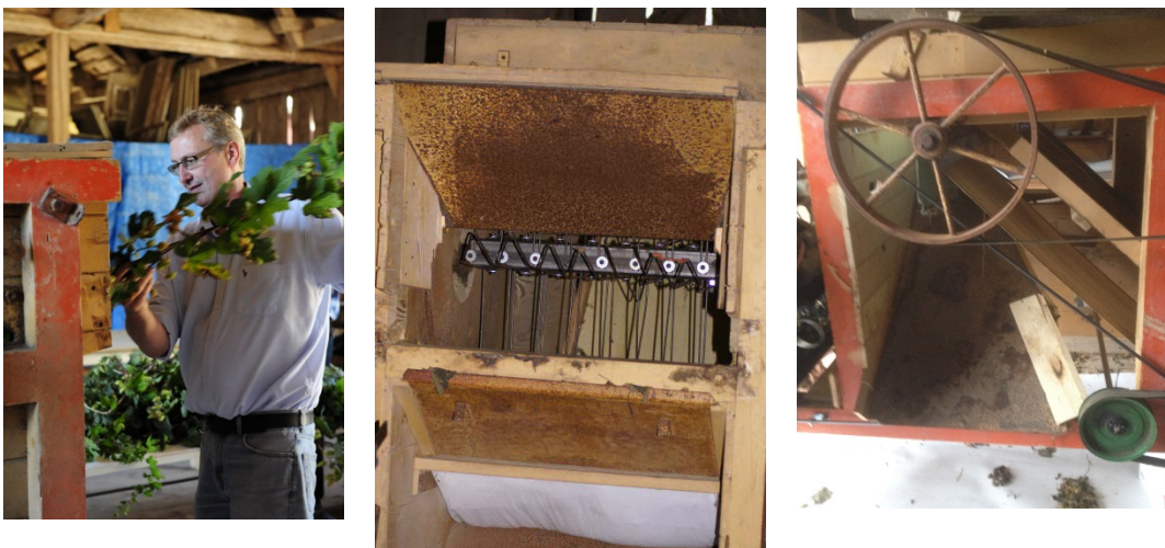
Figur 5. Plockmaskin för humle utvecklad vid Spännaregården, Mariestad. Rankorna matas manuellt in till den repande tröskcyklern. Rensningen sker på ett sluttande transportband. Foto: Gunilla Hellsten Boman
