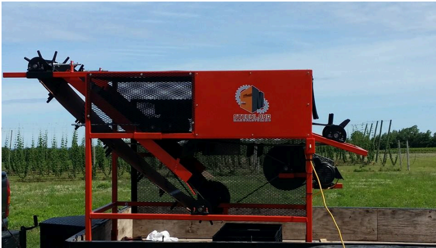
Figur 6. Plockmaskinen Hops Harvester HH 1000 från Steenland Manufacturing, USA. Maskinen är eldriven (110 V), uppgiven kapacitet två rankor per minut (Steenland, 2017). Pris år 2017: $12 000 (Steenland pers. medd., 2017).
