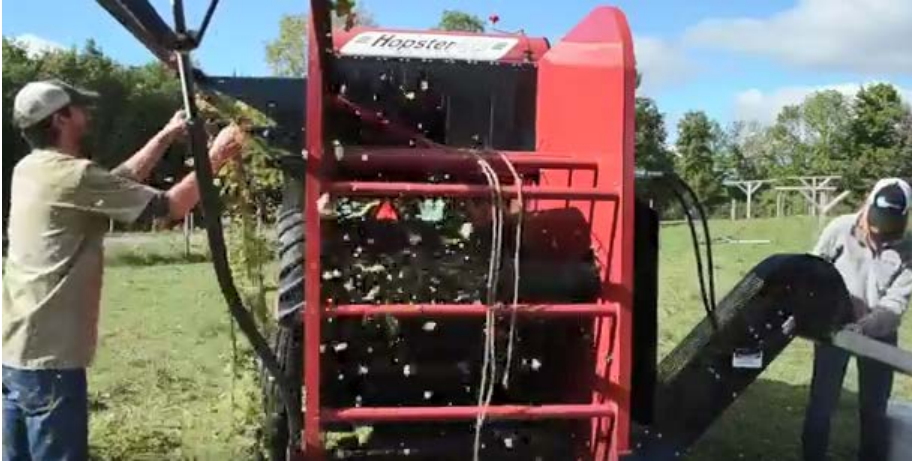
Figur 13. På Hopster 5 drar matarkedjan rankan genom maskinen och den ser ut att vara väl repad när den sedan knyts av manuellt. Kottarna matas ut åt sidan och tas om hand i lådor. Bildkälla: YouTube november 2017
