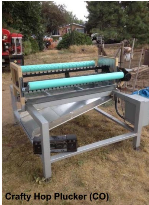
Figur 20a. Plockmaskinen "Crafty Hop Plucker" från Colorado, USA. Utrustningen repar kottarna från rankorna men rensar ej materialet. Uppgiven kapacitet 30-60 humlerankor per timme. Maskinen är eldriven. Angivet pris $5 000 (Callahan, 2013).
