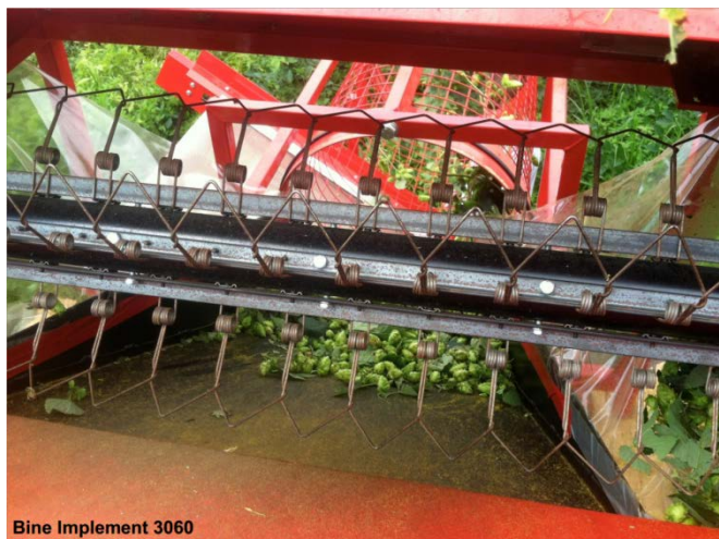
Figur 18. Plockmaskinen Bine Implement 3060. Utrustningen repar kottarna och rensar materialet. Eldrift, kapacitet 20-30 rankor per timme. Angivet pris $14 000 (Callahan, 2013).
