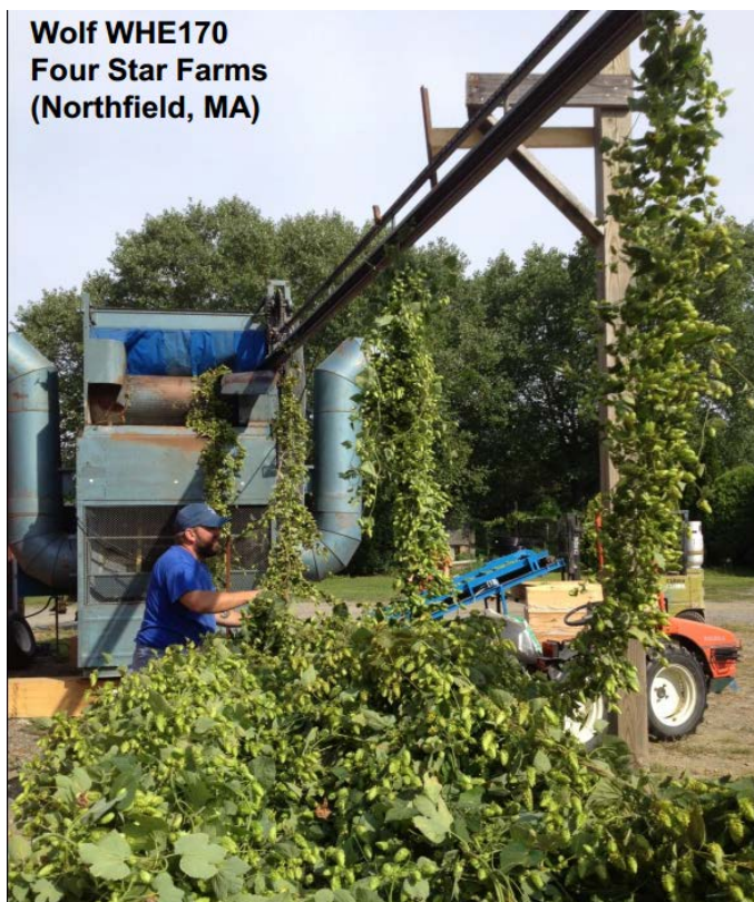
Figur 17. Repning och rensning av humle med den polsktillverkade plockmaskinen Wolf WHE 170. Kapaciteten är uppemot 170 rankor per timme. Maskinen kan även hacka rankorna. Angivet pris $43 500 (Callahan, 2013).
