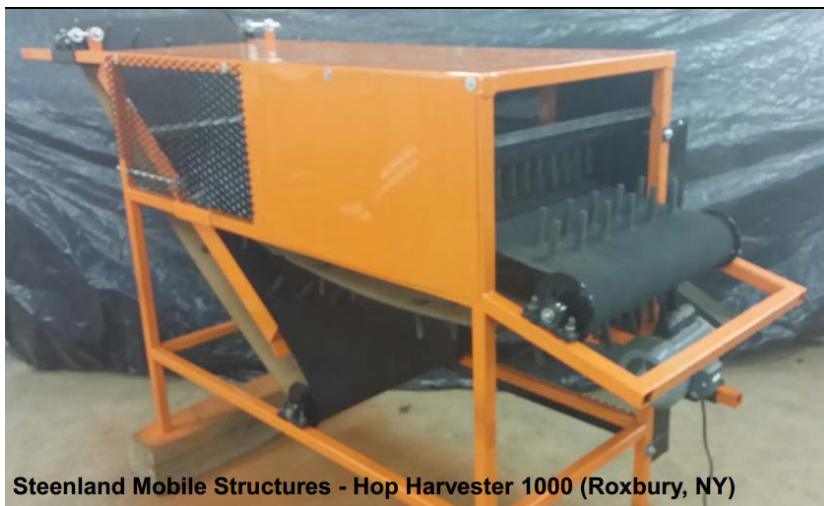
Figur 20b Plockmaskinen Hop Harvester 1000 från Steenland Mobile Structures, New York, USA. Utrustningen repar kottarna och rensar materialet. Maskinens repande fingrar är utförda i gummi i stället för stål vilket skulle kunna innebära skonsammare hantering. Eldrift, uppskattad kapacitet 120 rankor per timme. Uppskattat pris $14 000 (Callahan, 2013).
